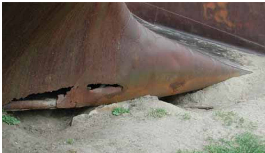
Georrodeerd cortenstaal van Groot Landschap van Wessel Couzijn, ondergraven door konijnen. Sloterpas Amsterdam. Foto: Rob Crèvecoeur.
